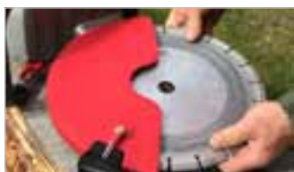
300 mm kappeskive med 110 mm skjæredybde.
